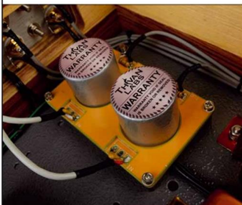
Die MC-Trafos machen einen ausgezeichneten Job
