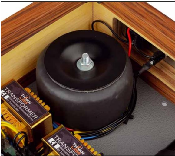
Ein Hüne von Netztrafo übernimmt die Versorgung des Gerätes
