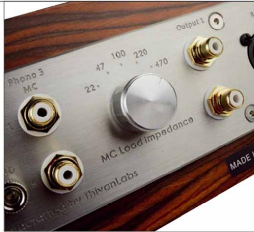
Die Eingangsimpedanz des MC-Eingangs ist per Drehschalter einstellbar
