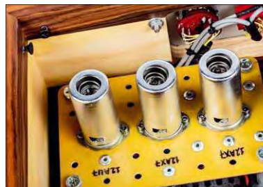
Diese drei Doppeltrioden stecken in Abschirmbechern gegen Einstrahlstörungen
