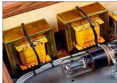
Diese beiden Trafos sind Ausgangsübertrager, die echt symmetrische Signale liefern
