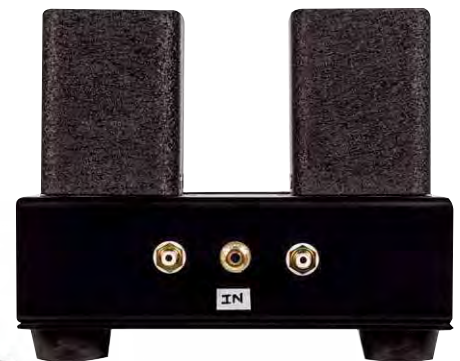
Vorne und hinten praktisch gleich: Auf jeder Seite des Übertragers gibt's Anschlussbuchsen und eine Erdungsklemme
