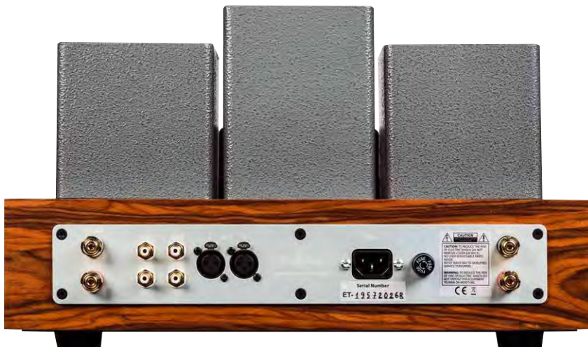
Rückseitig gibt's nur einen Lautsprecheranschluss für vorzugsweise Acht-Ohm-Boxen
